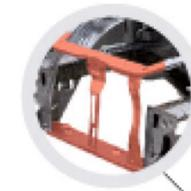
Zona de amortiguamiento: en un choque frontal, el impacto de la fuerza puede ser disminuída en esta zona, siendo razonablemente deformada antes de entrar en la cabina.
